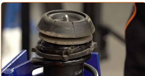
**25** Zategnite matico amortizerja. Uporabite kombinirani ključ №19. Uporabite nasadni ključ №9. Uporabite navorni ključ. Zategnite ga do navora 50 Nm.
