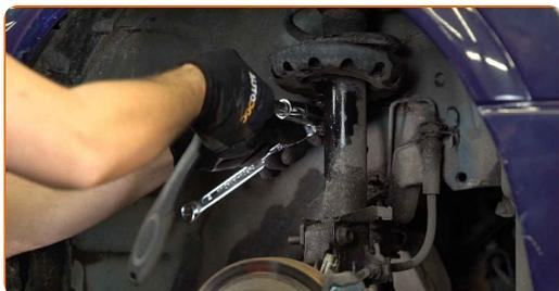
**13** Odvijte spodnji pritrdilni element, ki povezuje blažilnik s premnikom. Uporabite kombinirani ključ №18. Uporabite nasadni ključ №18. Uporabite udarni nasadni ključ.
