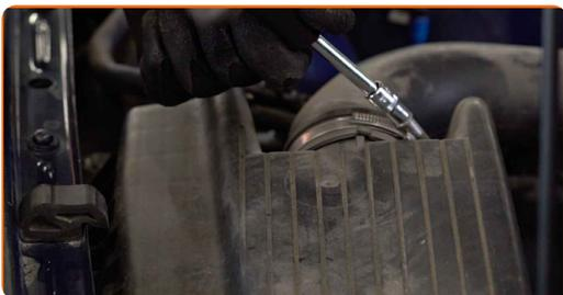
4 Odklopite dovodno cev zraka z ohišja zračnega filtra.
