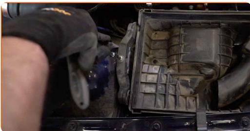
9 Odstranite ohišje zračnega filtra.
