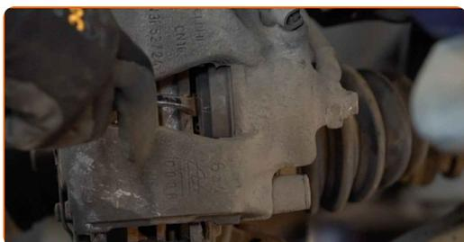
8 Odstranite pokrovčke manšete vodilnih zatičev zavornih čeljusti. Uporabite ploščat izvijač.
