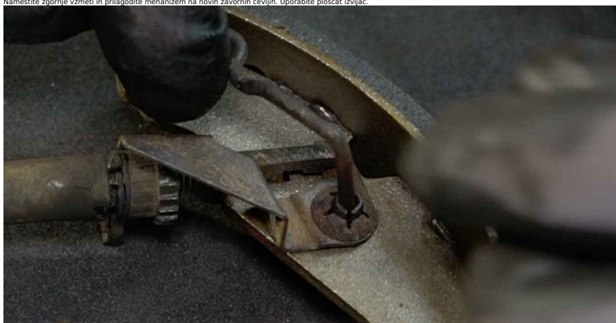
club.autodoc.si 11-18 36 Namestite novo desno zavorno čeljust.
