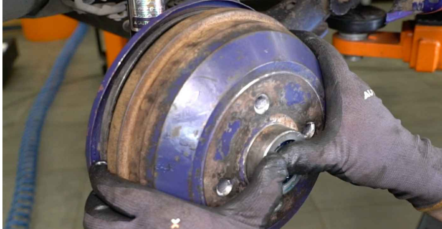
45 Namestite podložko kolesnega ležaja.
