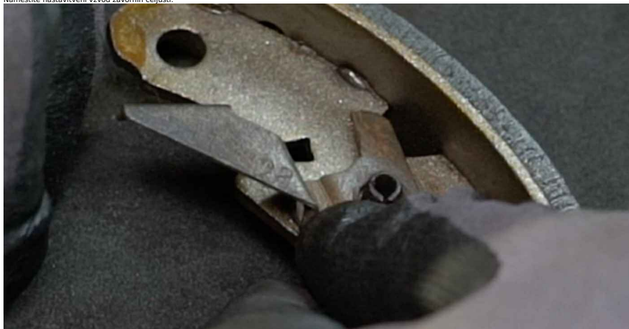
34 Namestite varovalni obroček.
