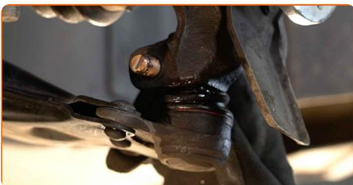
**38** Zategnite pritrditev krogličnega zgloba. Uporabite kombinirani ključ №17. Uporabite nasadni ključ №19. Uporabite navorni ključ. Zategnite ga do navora 50 Nm.
