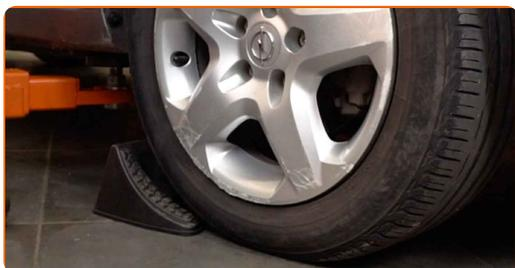
**3** Odvijte pritrdilni element pogonske gredi na pesto kolesa. Uporabite nasadni ključ N°32. Uporabite udarni nasadni ključ.
