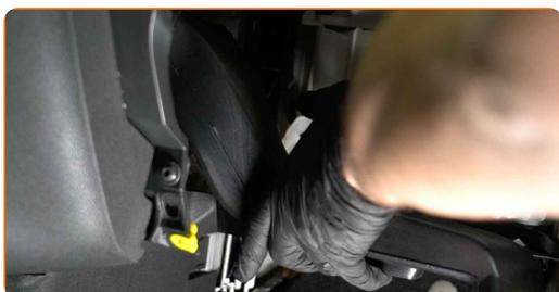
**17** Namestite pritrdilne elemente ohišja zračnega kanala.
