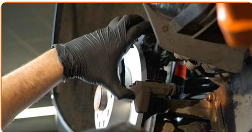
**31** Zategnite nosilec zavorne čeljusti. Uporabite XZN št. 14. Uporabite navorni ključ. Zategnite ga do navora 90 Nm.+90°
