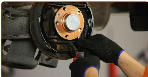
**22** Vstavite vodilo vzmeti v ustrezne odprtine. Uporabite klešče.
