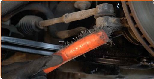
**18** Odvijte končno pritrdilno matico na volanskem členku. Uporabite nasadni ključ №19. Uporabite izvijač z zatikalom.
