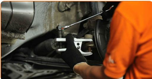
**20** Očistite pritrdilni element, ki povezuje nosilni zgib s premnikom. Uporabite žično krtačo. Uporabite sprej WD-40.
