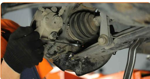
**24** Namestite pritrditev palice na stabilizator in ga zategnite. Uporabite nasadni ključ №16. Uporabite navorni ključ. Zategnite ga do navora 15 Nm.+90°
