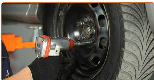
32 Spustite avto in z delanjem v navzkrižnem vrstnem redu, zategnite kolesne vijake. Uporabite kolesni nasadni nastavek št. 17 Uporabite navorni ključ. Zategnite ga do navora 120 Nm.
