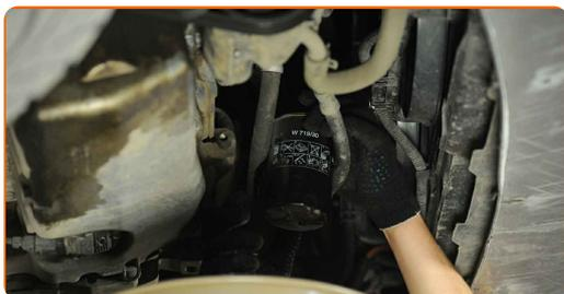
11 Očistite nosilec oljnega filtra. Uporabite večnamenski čistilni sprej.
