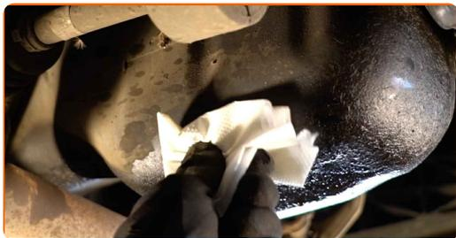
7 Privijte nov drenažni čep in ga zategnite. Uporabite nasadni ključ №19. Uporabite navorni ključ. Zategnite ga do navora 30 Nm.
