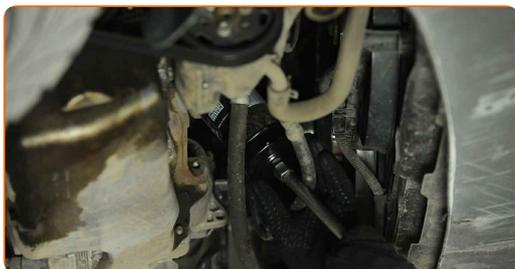
10 Odložite stari oljni filter v posodo.
