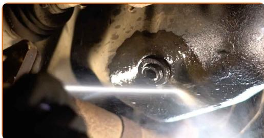
9 Odvijte oljni filter. Uporabite natični ključ 76/14-F. Uporabite izvijač z zatikalom.
