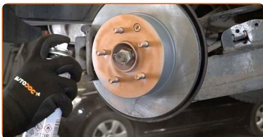
**26** Očistite površino zavornih kolutov. Uporabite čistilo zavor.
