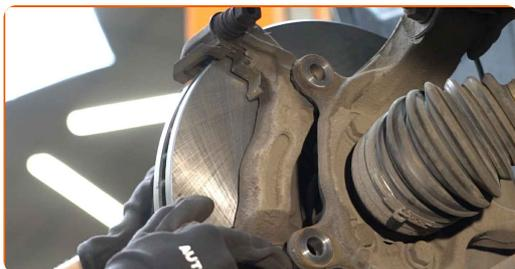
**20** Zategnite nosilec zavorne čeljusti. Uporabite nasadni ključ №19. Uporabite navorni ključ. Zategnite ga do navora 152 Nm.
