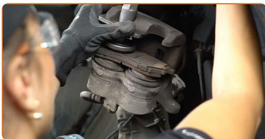
24 Namestite zavorno čeljust in jo privijte. Uporabite kombinirani ključ №17. Uporabite nasadni ključ №14. Uporabite navorni ključ. Zategnite ga do navora 34 Nm.
