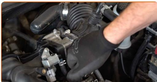
4 Odvijte sponke in pritrilne elemente cevi za dovod zraka v zračni filter. Uporabite nasadni ključ №10. Uporabite izvijač z zatikalom.
