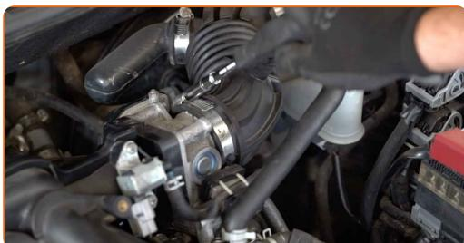
5 Odklopite dovodno cev zraka z ohišja zračnega fitra.
