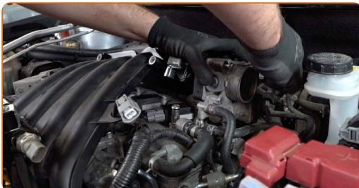
**30** Zategnite pritrdilne elemente dušilnega ventila. Uporabite nasadni ključ №8. Uporabite navorni ključ. Zategnite ga do navora 10 Nm.
