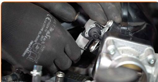
**32** Priključite dovodno cev zraka na ohišje zračnega filtra.
