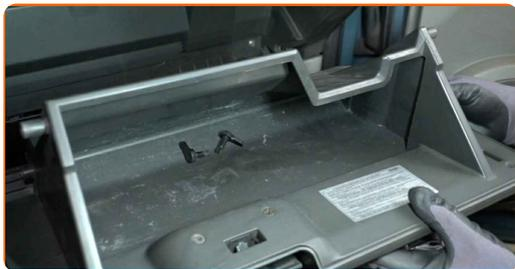
**4** Odvij pritrdilne elemente na zadnji plošči predala armature. Uporabite vijačni nastavek T20.
