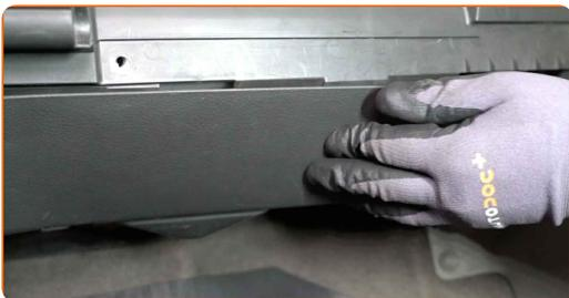
**16** Privij pritrdilne elemente na zadnjo ploščo predala armature. Uporabite vijačni nastavek T20.
