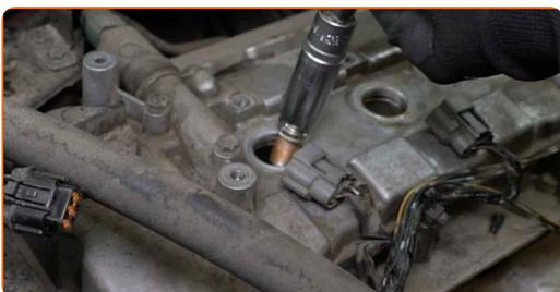
**27** Vstavite nove svečke in jih pričvrstite. Uporabite nastavek ključa za vžigalne svečke št. 16. Uporabite navorni ključ. Zategnite ga do navora 25 Nm.
