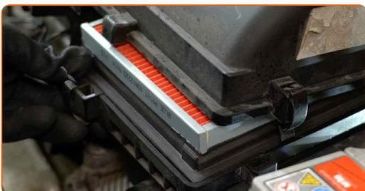
**45** Zapahnite držala ohišja zračnega filtra.
