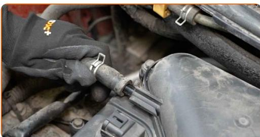
**41** Obdelajte priključke pokrova motorja. Uporabite dielektrično mast.
