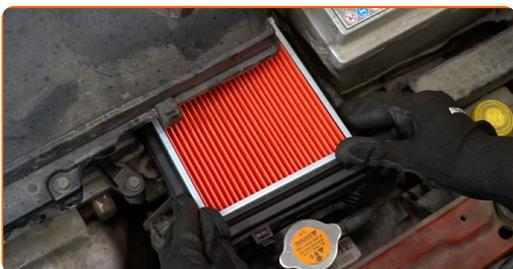
**44** Namestite ohišje zračnega filtra.
