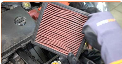
**8** Postavite ohišje zračnega filtra na stran.
