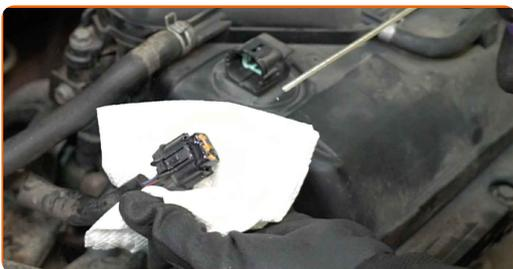
**42** Pritrdite priključke na pokrov motorja. Uporabite ploščat izvijač.
