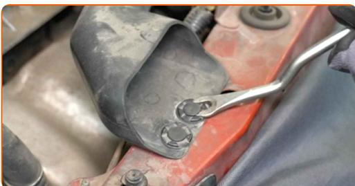
**4** Odstranite cev za dovod zraka.
