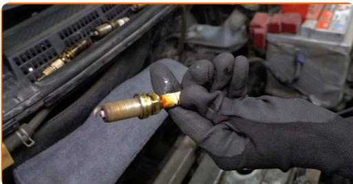
**25** Nanesite tanek sloj posebnega visokotemperaturnega maziva proti zatikanju na navoje novih vžigalnih svečk.
