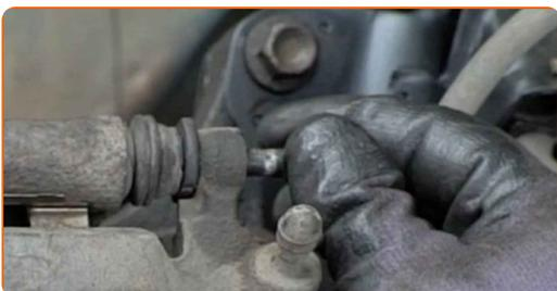
**33** Zategnite pritrdilne elemente zavorne čeljusti. Uporabite nasadni ključ №14. Uporabite navorni ključ. Zategnite ga do navora 32 Nm.
