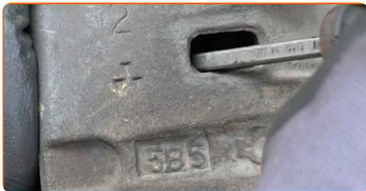
**8** Očistite pritrdilne elemente zavornih čeljusti. Uporabite žično krtačo. Uporabite sprej WD-40.
