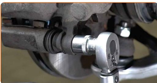
**34** Obdelajte površino, kjer se zavorni kolot stika s platiščem. Uporabite keramično pasto.
