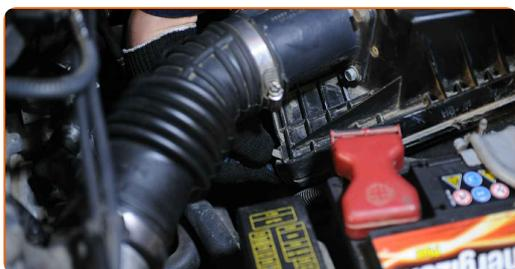
**9** Odvijte vijake nosilca filtra za zrak. Uporabite nasadni ključ №10. Uporabite izvijač z zatikalom. Uporabite Phillips križni izvijač.
