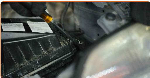
**30** Zavarujte pritrdilni element kanala za dovod zraka. Uporabite ploščat izvijač.
