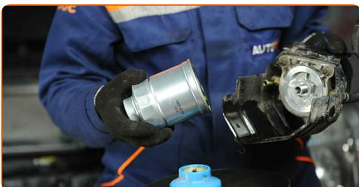
**17** Očistite ohišje in pokrov filtra za gorivo. Uporabite večnamenski čistilni sprej.
