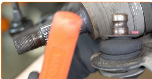
**47** Obdelajte ozobje pogonske gredi homokinetičnega zgloba. Uporabite bakreno mast.
