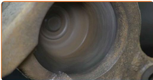
**40** Namestite novi pritrdilni obroč senzorja ABS.
