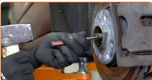
**10** Očistite nosilce zavornih čeljusti. Uporabite žično krtačo. Uporabite sprej WD-40.
