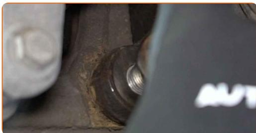
**68** Zategnite pritrdilne elemente nosilca zavornega sedla. Uporabite nasadni ključ №17. Uporabite navorni ključ. Zategnite ga do navora 105 Nm.
