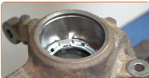
**41** Pritisnite nov ležaj v premnik. Uporabite komplet puše in ležaja gonilnika.
