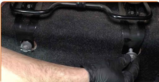
**41** Privijte sprednje pritrdilne elemente nosilcev zadnjih sedežev. Uporabite nasadni ključ №17. Uporabite izvijač z zatikalom.
