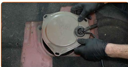
**38** Obrnite držala pokrova modula črpalke goriva, da ga zablokirate na mestu. Uporabite Phillips križni izvijač.
