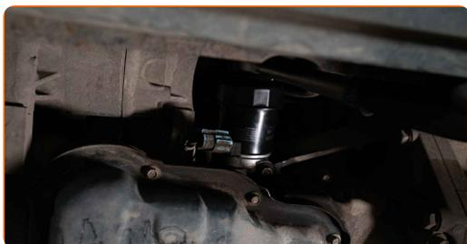
14 Odstranite oljni filter. Pripravite posodo za stari oljni filter. Odložite stari oljni filter v posodo.
