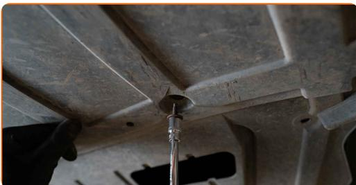
8 Odstranite pokrov oljnega korita. Uporabite nasadni ključ №10. Uporabite ploščat izvijač.
