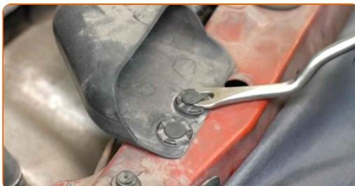
4 Odstranite cev za dovod zraka.
