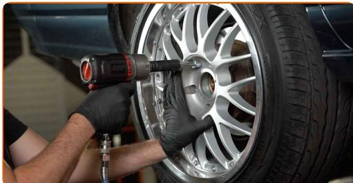
**3** Odvijte vse komponente, ki zavirajo odstranitev rezervnega dela s pušo v notranjosti.
