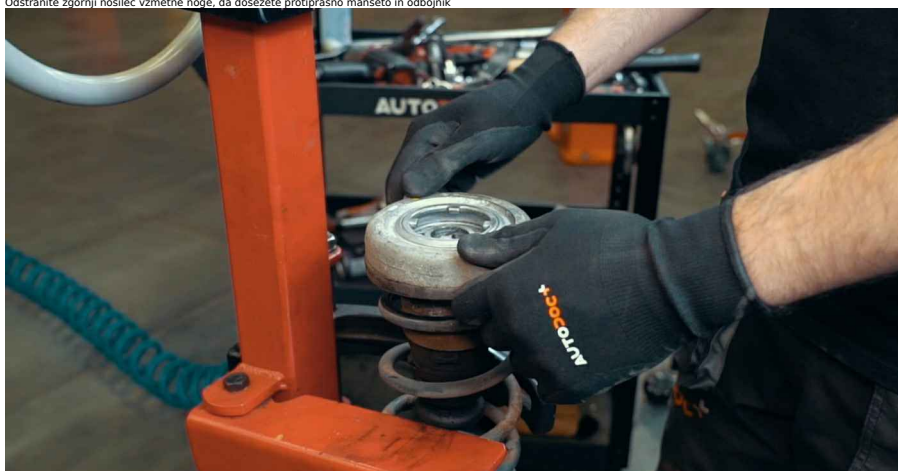
Pozor! • Odbojnik je lahko nameščen na batnici ali pritrjen na nosilec • Protiprašna manšeta je lahko nameščena na odbojniku, nameščena med vzmetjo in nosilecem ali pritrjena na nosilec.
