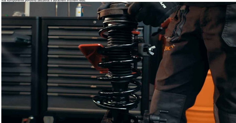
Pomembno! • Bodite pozorni na položaj nosilca vzmetne noge, da se prepričate, da je obrnjen v pravo smer
