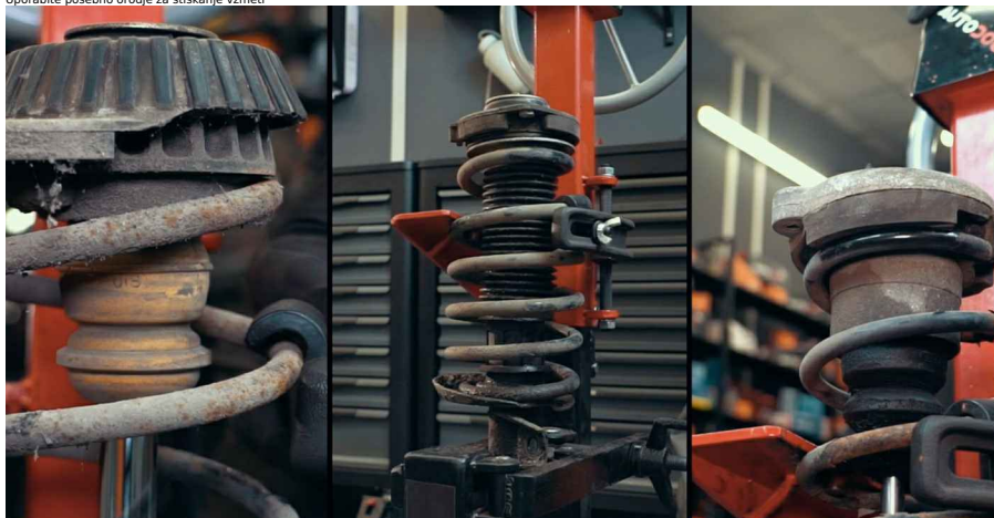
13 Odstranite zgornji nosilec vzmetne noge, da dosežete protiprašna manšeta in odbojnik
