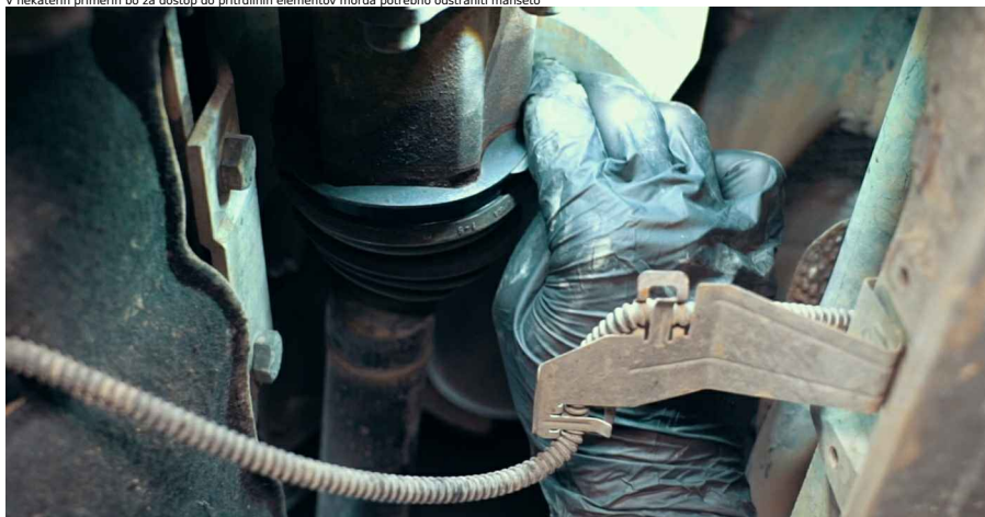
9 V nekaterih primerih bo za dostop do pritrdilnih elementov morda potrebno odstraniti manšeto
