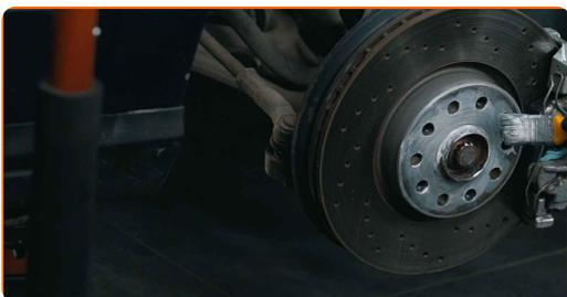
**53** Očistite površino zavornih kolotov
