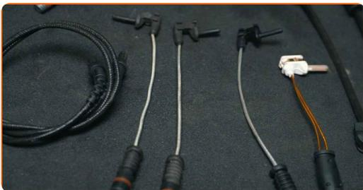
10 Ko so zavorne ploščice obrabljene, se kontakt senzorja obrabe zapre in pošlje ustrezen signal v računalnik v vozilu
