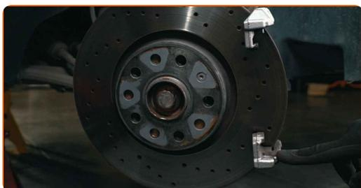
**26** Če je notranja zavorna ploščica bolj obrabljena kot zunanja, preverite stanje vodilnih čepov zavornega sedla
