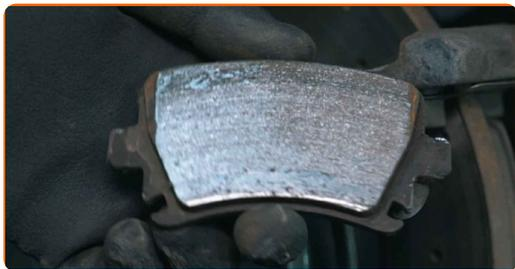
**24** Če so njihove torne obloge enakomerno obrabljene, to pomeni, da vse komponente sistema delujejo pravilno
