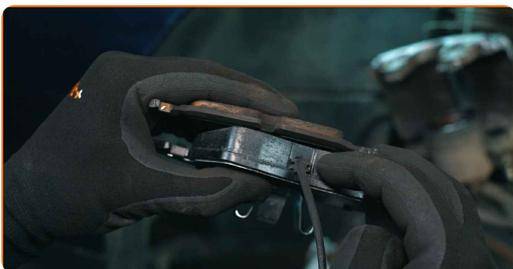
**11** Senzorji obrabe zavornih ploščic so za enkratno uporabo in jih je treba zamenjati skupaj z zavornimi ploščicami
