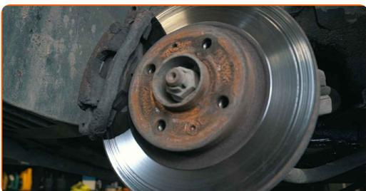
**14** Za dostop do zavornih ploščic dvignite avto in odstranite kolesa
