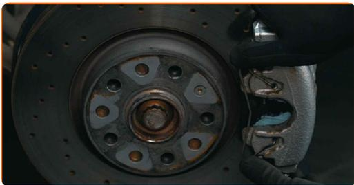
**52** Površino zavornega koluta, ki bo v stiku s platiščem kolesa, obdelajte z antikorozijskim sredstvom
