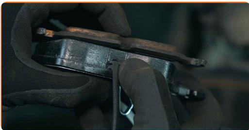
**12** Če je senzor mehanski, se začne dotikati zavornega koluta, ko je zavorna ploščica obrabljena
