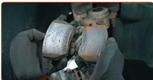
**25** Če je zunanja zavorna ploščica bolj obrabljena kot notranja, se med premikanjem zatakne v pritrdilnih sponkah v nosilcu
