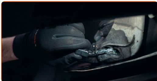
**18** Po potrebi odstranite kabelsko napeljavo senzorja
