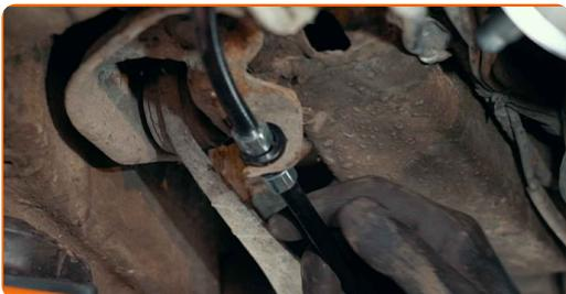
**21** Namestite kabel ročne zavore na nastavek zavorne čeljusti. Uporabite rezalne klešče. Uporabite lomilko.
