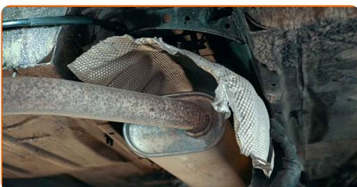
**24** Privijte pritrdilne elemente toplotnega ščita izpuha. Uporabite nasadni ključ №10. Uporabite izvijač z zatikalom.
