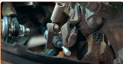
**22** Prilagodite napetost parkirnega zavornega kabla. Uporabite nasadni ključ №16. Uporabite izvijač z zatikalom.
