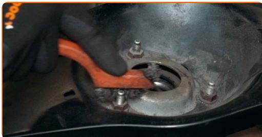
**4** Sprostite zgornje pritrdilne elemente vzemetne noge (trije kosi). Uporabite nasadni ključ №13. Uporabite izvijač z zatikalom.
