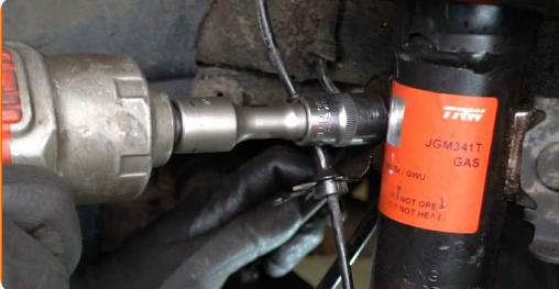
8 Odvijte pritrdilni element, ki povezuje jarmov drog na palico stabilizatorja. Uporabite kombinirani ključ №17. Uporabite nasadni ključ №17. Uporabite izvijač z zatikalom.
