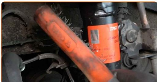
7 Odvijte pritrdilni element, ki povezuje jarmov drog na blažilnik. Uporabite kombinirani ključ №17. Uporabite nasadni ključ №17. Uporabite izvijač z zatikalom.
