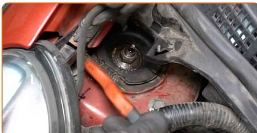
**6** Sprostite zgornje pritrdilne elemente vzmetne noge. Uporabite nasadni ključ №13. Uporabite izvijač z zatikalom.
