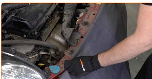
**3** Odvijte pritrdilne elemente plastične rešeteke pod vetrobranskim steklom. Uporabite orodje za odstranitev sponke. Uporabite Phillips križni izvijač.
