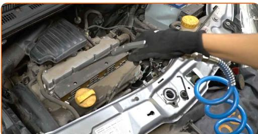
**13** Odklopite konektor z vžigalne tuljave. Uporabite ploščat izvijač.
