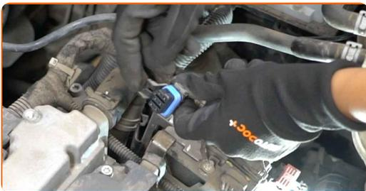
**14** Odvijte vijake vžigalne tuljave. Uporabite vijalni nastavek T30. Uporabite izvijač z zatikalom.
