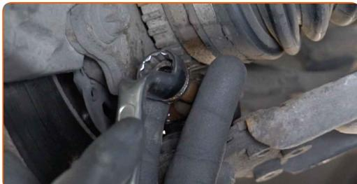
9 Odvijte pritrditev sprednje roke. Uporabite kombinirani ključ №18. Uporabite nasadni ključ №18. Uporabite izvijač z zatikalom.
