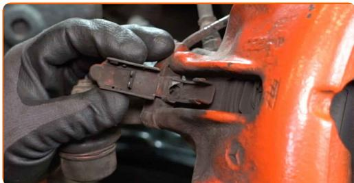
**9** Očistite pritrdilne elemente zavornih čeljusti. Uporabite žično krtačo. Uporabite sprej WD-40.
