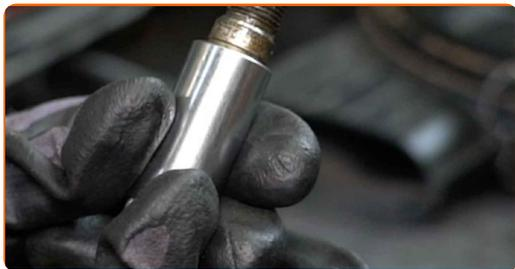
**11** Nanesite tanek sloj posebnega visokotemperaturnega maziva proti zatikanju na navoje novih vžigalnih svečk.
