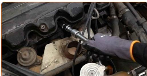
**13** Vstavite nove svečke in jih pričvrstite. Uporabite nastavek ključa za vžigalne svečke št. 16. Uporabite navorni ključ. Zategnite ga do navora 22 Nm.
