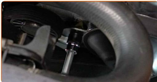
4 Sprostite napenjalec jermenja. Uporabite nasadni ključ №13. Uporabite izvijač z zatikalom.
