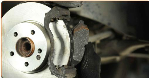
Menjava: zavornih ploščic – MERCEDES-BENZ SPRINTER 3-t Avtobus (906).
