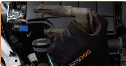
**6** Odvijte vžigalne svečke. Uporabite nastavek ključa za vžigalne svečke št. 16. Uporabite izvijač z zatikalom.
