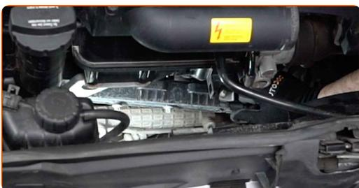
**4** Odvijte nosilec vžigalne tuljave. Uporabite nasadni ključ №E11. Uporabite izvijač z zatikalom.
