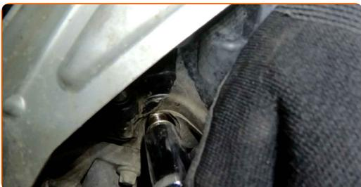
**8** Nanesite tanek sloj posebnega visokotemperaturnega maziva proti zatikanju na navoje novih vžigalnih svečk.
