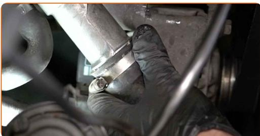
**29** Pritrdite sponko cevi hladilne tekočine. Uporabite nasadni ključ №7. Uporabite izvijač z zatikalom.
