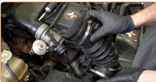
**5** Pokrijte nastavek dušilnih loput s krpo iz mikrovlaken, da preprečite vdor prahu in umazanije v sistem.
