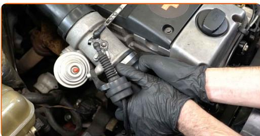
**39** Zategnite cevne objemke zračnega filtra. Uporabite nasadni ključ №7. Uporabite izvijač z zatikalom.
