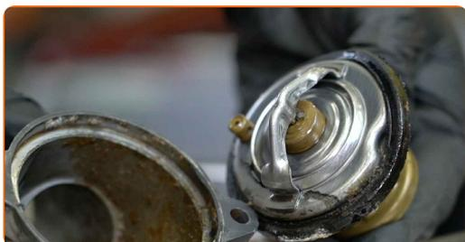
**23** Očistite montažno mesto termostata. Uporabite žično krtačo. Uporabite večnamenski čistilni sprej.
