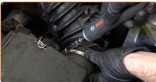
**4** Odstranite cev za dovod zraka.
