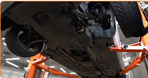
8 Odklopite vtič senzorja obrabe zavornih oblog. Odstranite konektor senzorja obrabe zavornih ploščic. Uporabite okrogle klešče.
