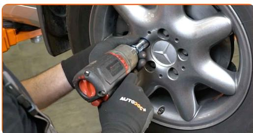
**34** Spustite avto in z delanjem v navzkrižnem vrstnem redu, zategnite kolesne vijake. Uporabite kolesni nasadni nastavek št. 17 Uporabite navorni ključ. Zategnite ga do navora 110 Nm.
