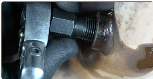
**13** Obdelajte lambda sondo. Uporabite visokotemperaturno keramično pasto.
