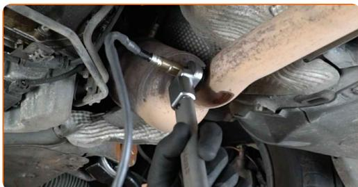
**16** Obdelajte konektor lambda sonde. Uporabite dielektrično mast.
