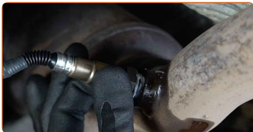
**15** Pričvrstite pritrdilni element lambda sonde. Uporabite kombinirani ključ №22. Uporabite navorni ključ. Zategnite ga do navora 51 Nm.
