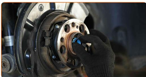
**82** Zategnite pesto. Uporabite nasadni ključ №32. Uporabite navorni ključ. Zategnite ga do navora 170 Nm.+45°
