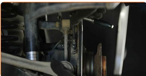
**75** Namestite prečno povezavo stabilizatorja.
