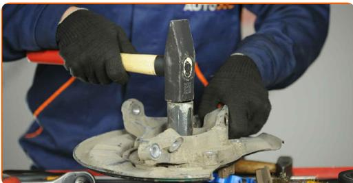
**44** Odvijte nosilec pesto ležaja. Uporabite nasadni ključ N°E12. Uporabite izvijač z zatikalom.
