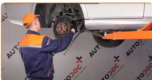
**33** Odvijte zgornje pritrdilne elemente kontrolne ročice. Uporabite kombinirani ključ №18. Uporabite nasadni ključ №E18. Uporabite izvijač z zatikalom.
