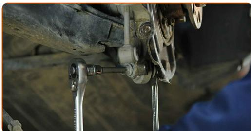
**28** Odstranite pritrdilni vijak. Uporabite vijačni nastavek M12. Uporabite izvijač z zatikalom.
