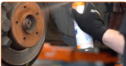
**91** Očistite površino zavornih kolutov. Uporabite čistilo zavor.
