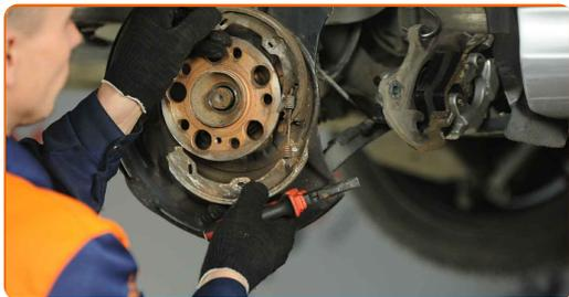
**18** Odklopite kabel parkirne zavore. Uporabite ploščat izvijač.
