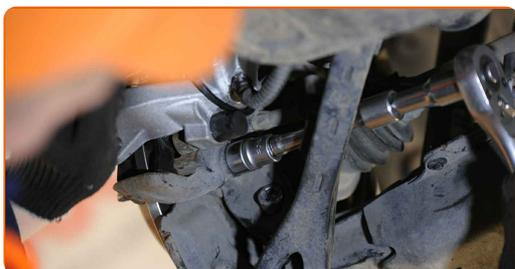
**89** Obdelajte vse dele prečnega vodila. Obdelajte vse spoje opornika stabilizatorja. Uporabite bakreno mast.
