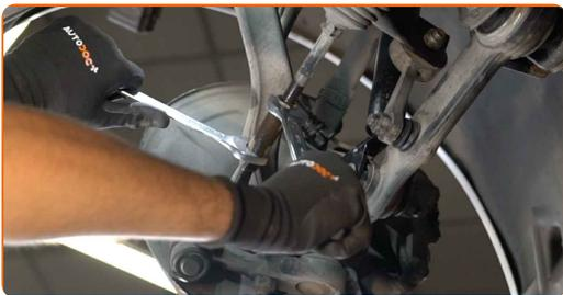
**9** Odvijte končno pritrdilno matico na volanskem členku. Uporabite nasadni ključ №21. Uporabite udarni nasadni ključ.
