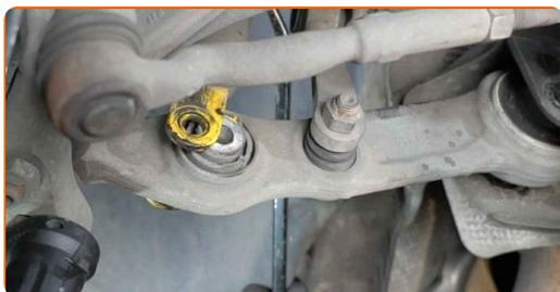
**19** Odvijte pritrdilni element, ki povezuje jarmov drog na palico stabilizatorja. Uporabite kombinirani ključ №21. Uporabite imbus št. H12. Uporabite izvijač z zatikalom.
