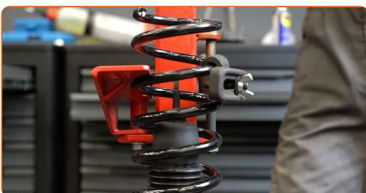
**37** Namestite zgornji nosilec opornika in ležaj nosilca opornika.
