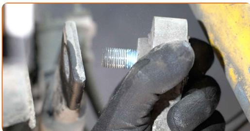
**21** Odvijte pritrdilne elemente na vrhu nosilca amortizerja.
