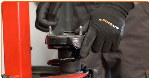
**38** Zategnite matico amortizerja. Uporabite nasadni ključ za blažilnik št. DD6. Uporabite nasadni ključ №18. Uporabite navorni ključ. Zategnite ga do navora 23 Nm.
