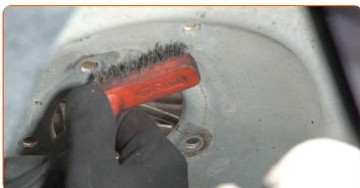
44 Očistite nosilce in ležaje prečnega vodila. Uporabite žično krtačo. Uporabite sprej WD-40.
