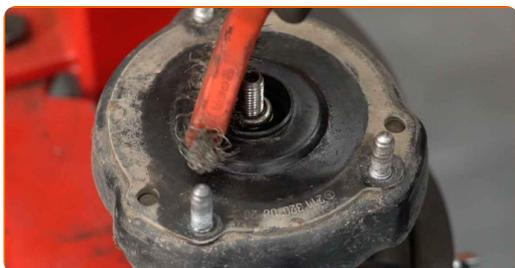
**27** Odstranite matico oporne batnice. Uporabite nasadni ključ №17. Uporabite imbus št. H6. Uporabite izvijač z zatikalom.
