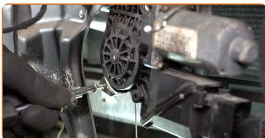
**32** Pritrdite konektor na motor električnega okna.
