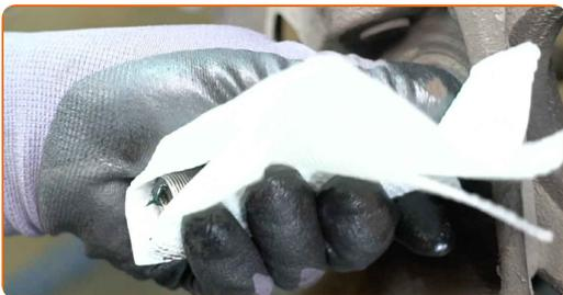
**23** Očistite senzor ABS. Uporabite čistilno krtačo iz najlona. Uporabite večnamenski čistilni sprej.
