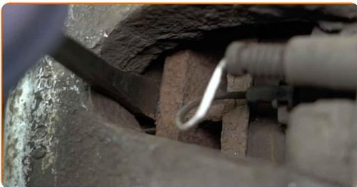
**9** Očistite nosilce zavornih čeljusti. Uporabite žično krtačo. Uporabite sprej WD-40.
