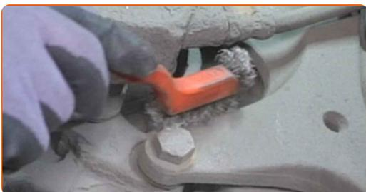
**10** Odvijte pritrdilne elemente nosilca zavornega sedla. Uporabite nasadni ključ №18. Uporabite izvijač z zatikalom.
