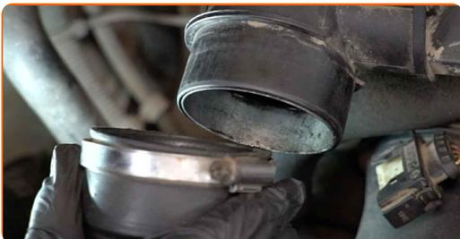
**6** Odstranite pritrdilne vijake pokrova zračnega filtra. Uporabite nasadni ključ N°E11. Uporabite izvijač z zatikalom.
