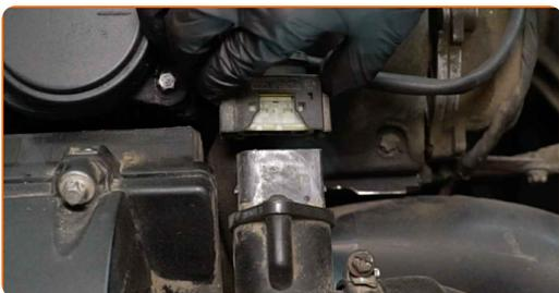
**4** Sprostite pritrdilno objemko, ki povezuje zračni kanal na ohišje zračnega filtra. Uporabite nasadni ključ №7. Uporabite izvijač z zatikalom.
