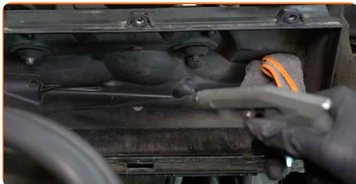
**11** Odstranite krpo iz mikrovlaknen iz cevi za dovod zraka.
