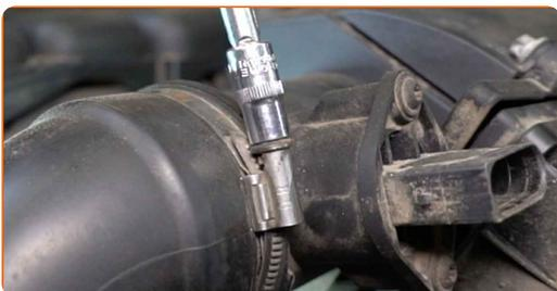
**5** Odklopite dovodno cev zraka z ohišja zračnega filtra.
