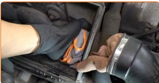
**10** Očistite pokrov zračnega filtra in ohišje.
