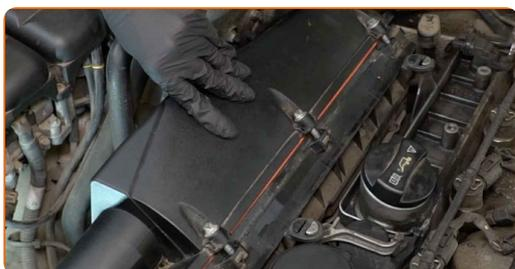
**14** Privijte pritrdilne vijake pokrova zračnega filtra. Uporabite nasadni ključ №E11. Uporabite izvijač z zatikalom.
