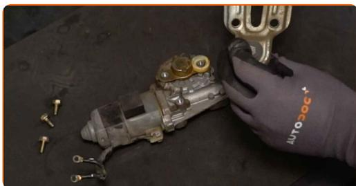
**20** Namestite in privijte pritrdilne elemente motorja na novi mehanizem regulatorja okna. Uporabite nasadni ključ №10. Uporabite navorni ključ. Zategnite ga do navora 8 Nm.
