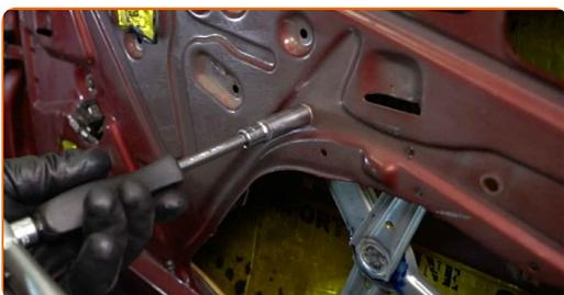
**24** Obdelajte terminale mehanizma regulatorja okna. Uporabite dielektrično mast.
