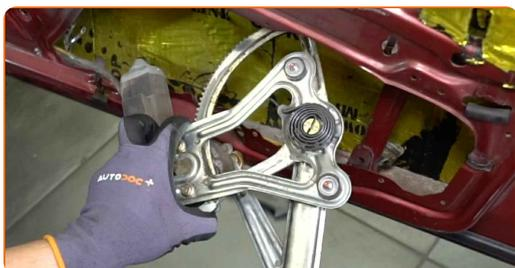
**18** Odvijte pritrdilne elemente motorja električnega okna. Uporabite nasadni ključ №10. Uporabite izvijač z zatikalom.
