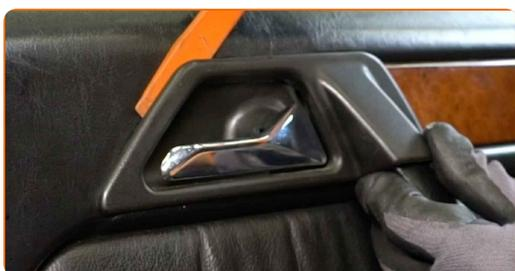
**5** Odvijte pritrdilni element vratnega panela. Uporabite nasadni ključ №10. Uporabite izvijač z zatikalom.
