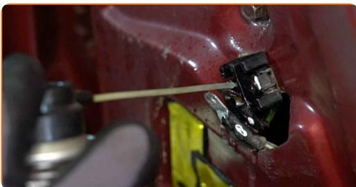
**25** Privijte terminale mehanizma regulatorja okna. Uporabite Phillips križni izvijač.
