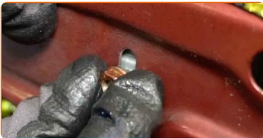
**23** Zategnite pritrdilne elemente sklopa regulatorja okna. Uporabite nasadni ključ №10. Uporabite navorni ključ. Zategnite ga do navora 8 Nm.
