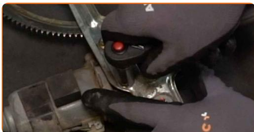
**19** Odstranite motor električnega okna.
