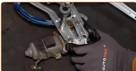
**21** Namestite novi mehanizem regulatorja okna.
